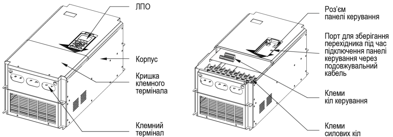
Рисунок 3.4 – Конструкція ПЧВ модифікацій 75КУ/90КЛ...220КУ/250КЛ (тип корпусу 3)
