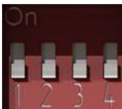
Рисунок 6.13 – DIP-перемикач . Джампер 2 в положенні OFF
