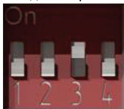
Рисунок 9.64 – DIP-перемикач. Джампер 3 в положенні ON
