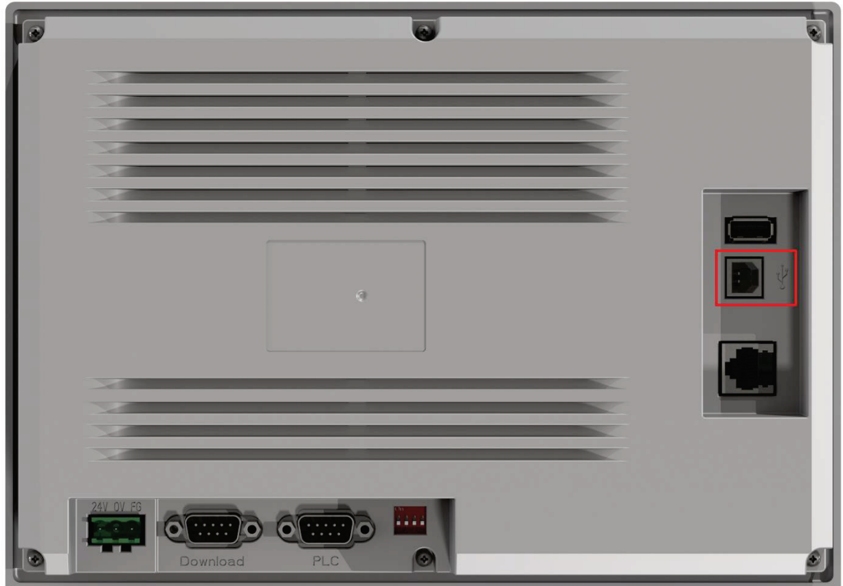
Рисунок 6.1 – Зовнішній вигляд задньої кришки панелі СПЗхх-Р (порт USB B, обведений червоним)
