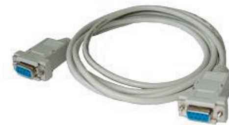
Рисунок 6.8 – Зовнішній вигляд нуль-модемного кабелю
