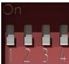
Рисунок 6.6 – DIP-перемикач. Джампер 2 в положенні OFF
