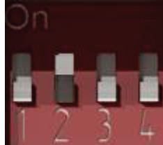
Рисунок 6.4 – DIP-перемикач. Джампер 2 в положенні ON
