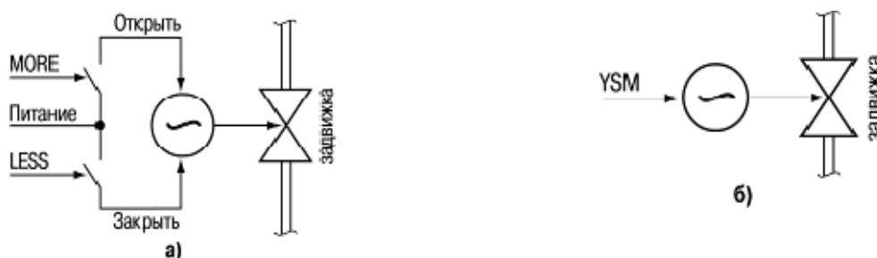
Рис. 2.10. Схемы управления задвижкой: а) дискретным сигналом, б) аналоговым сигналом
