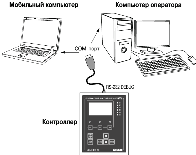
Рисунок 4.1 – Вариант подключения к ПК для программирования контроллера через порт RS-232 DEBUG
