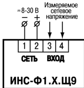
Рисунок Б.2 – Схема подключения прибора ИНС-Ф1.х.Щ9
