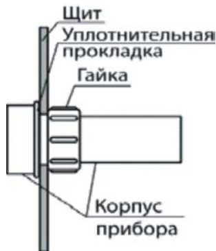
Рисунок 5.2 – Монтаж прибора ИНС-Ф1.Х.Щ9 в щит
