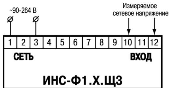
Рисунок Б.1 – Схема подключения прибора ИНС-Ф1.х.Щ3
