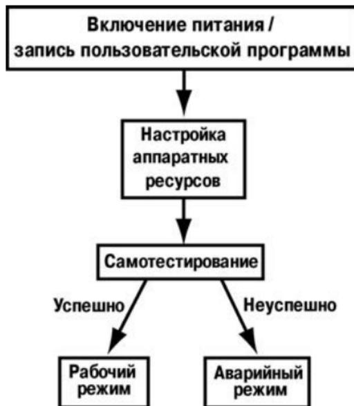
Рисунок 3.2 – Алгоритм запуска прибора
