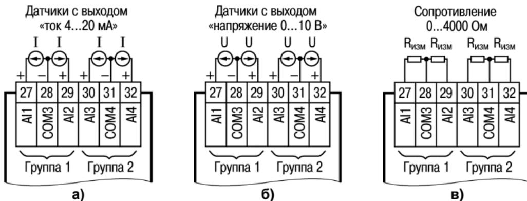
**Рисунок 7.7 – Схема подключения к аналоговым входам:**
