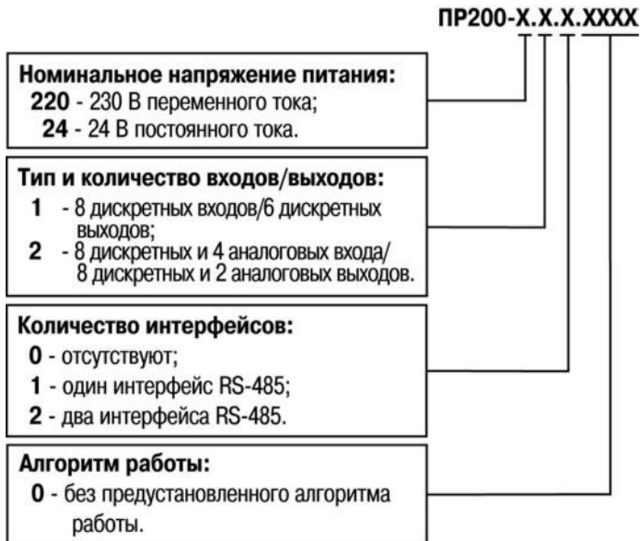
Пример полной записи обозначения реле в конструкторской документации:
