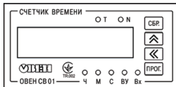
Рисунок 3.5 – Внешний вид лицевой панели прибора для корпуса щитового (Щ2) крепления
