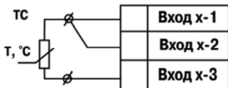
Рисунок Б.9 – Схема подключения термопреобразователя сопротивления
