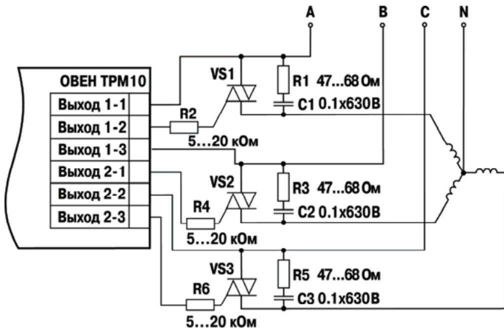
Рисунок Б.5 – Схема подключения трех симисторных оптопар
