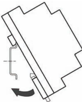
Рисунок 5.3 – Монтаж прибора с креплением на DIN-рейку
