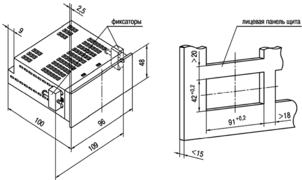
Рисунок А.4 – Прибор щитового крепления Щ2
