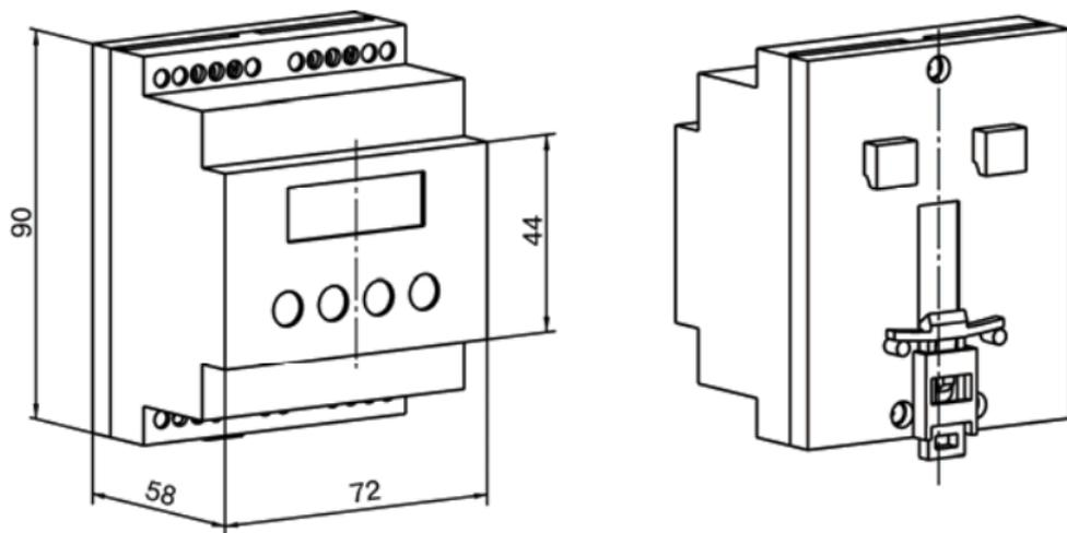
**Рисунок А.5 – Прибор с креплением на DIN-рейку**
