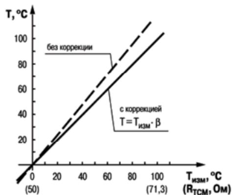
Рисунок 3.4 – Коррекция «наклон характеристики»
