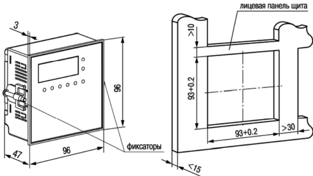
Рисунок А.3 – Прибор щитового крепления Щ11
