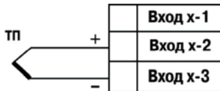
Рисунок Б.10 – Схема подключения преобразователя термоэлектрического
