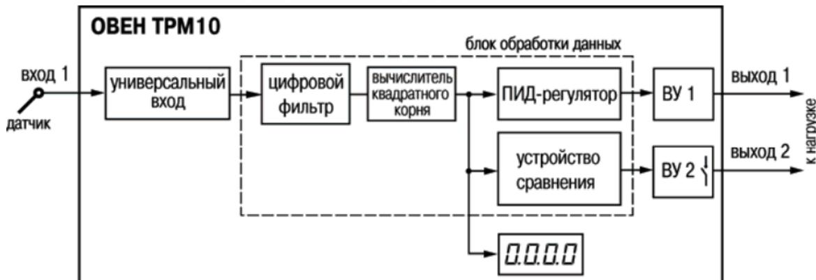
Рисунок 3.1 – Структурная схема прибора
