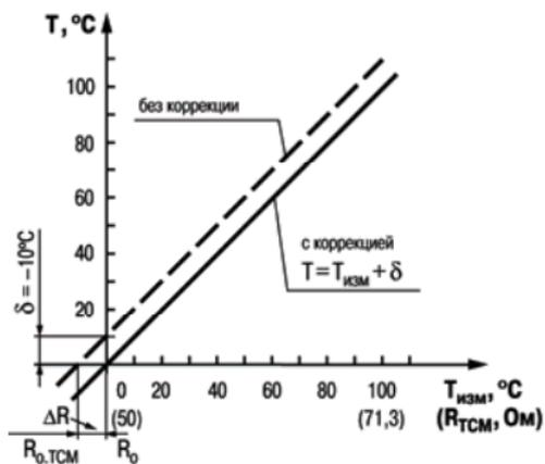
Рисунок 3.3 – Коррекция «сдвиг характеристики»
