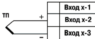
Рисунок Б.6 – Схема подключения преобразователя термоэлектрического
