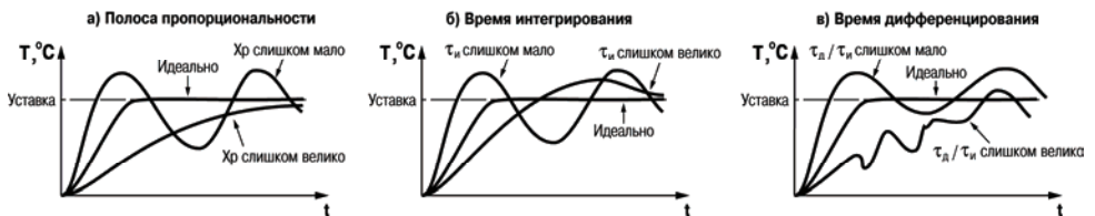
Рисунок Г.3 – Примеры графиков переходной функции
