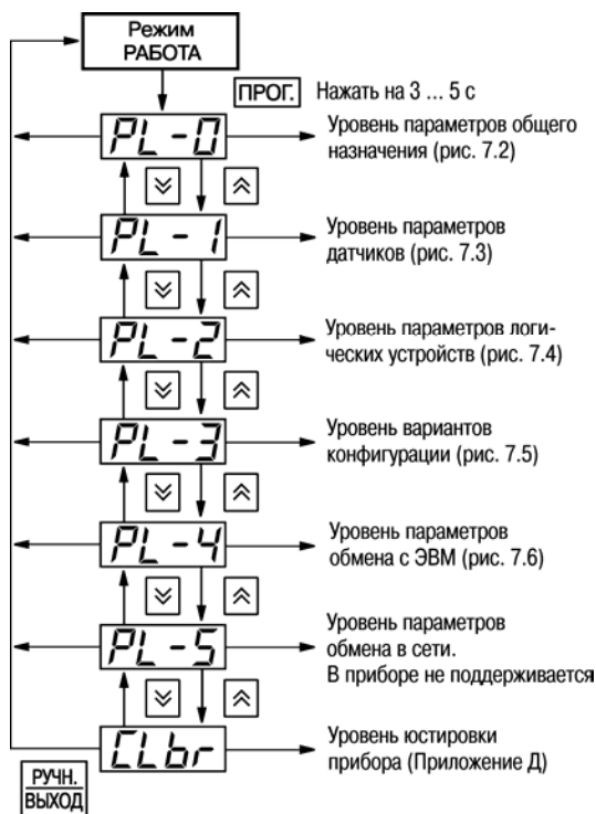
Рисунок 6.1 – Схема выбора уровня программируемых параметров
