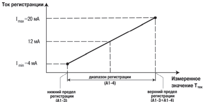
Рисунок 3.14 – Принцип формирования тока регистрации
