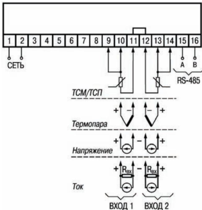
Рисунок В.1 – Общая схема подключения прибора
