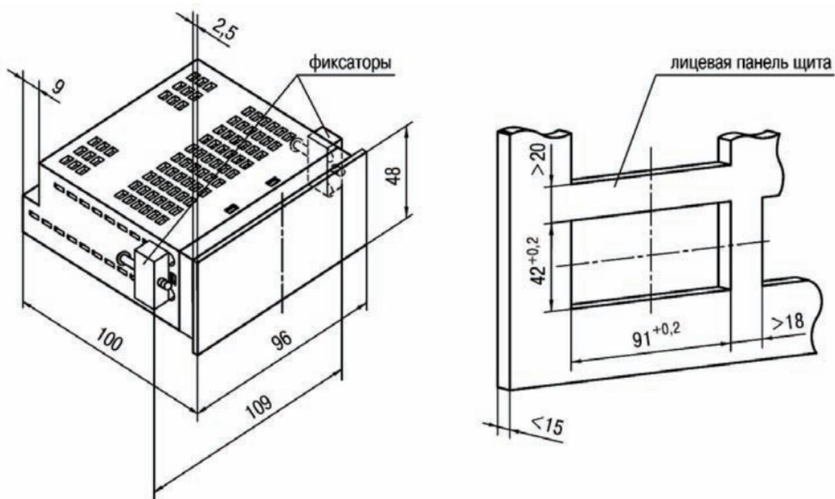
Рисунок А.3 – Прибор щитового крепления Щ2
