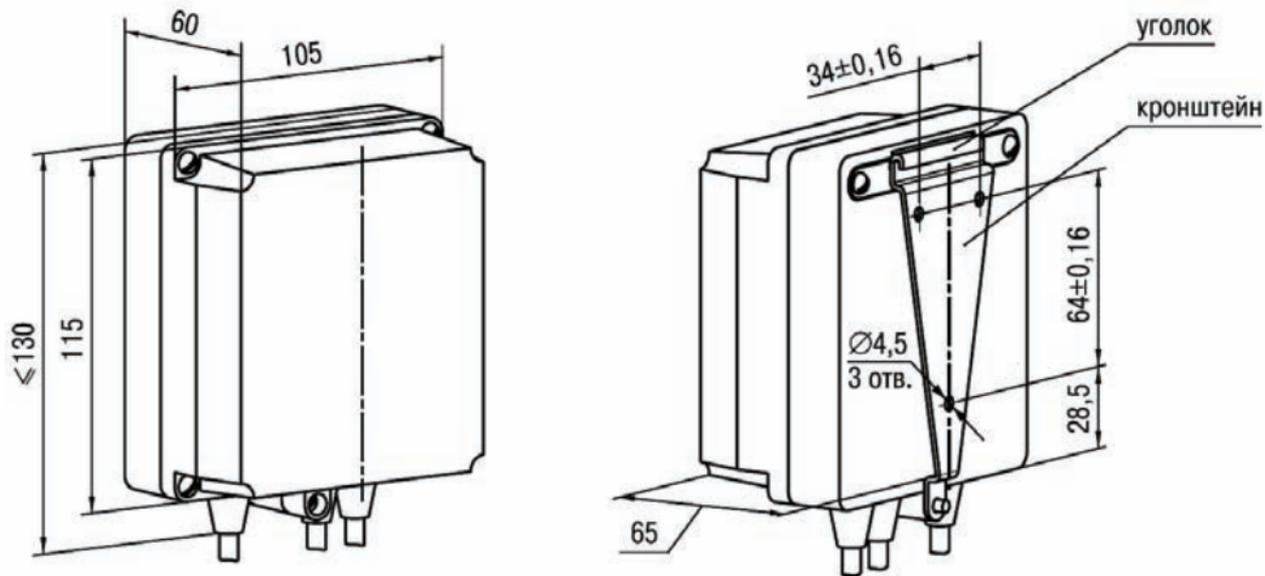
Рисунок А.1 – Прибор настенного крепления Н
