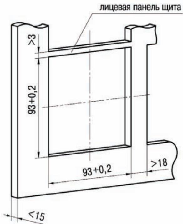
Рисунок А.2 – Прибор щитового крепления Щ1
