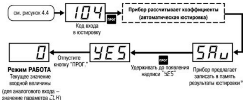
**Рисунок Д.2 – Последовательность действий при калибровке наклона характеристики ТС или датчика с унифицированным выходным сигналом**
