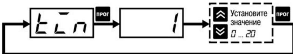
**Рисунок 4.6 – Схема установки значения параметров**
