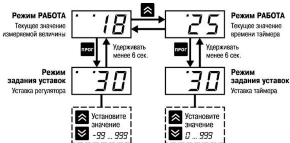
Рисунок 4.3 – Схема задания уставок регулятора и таймера
