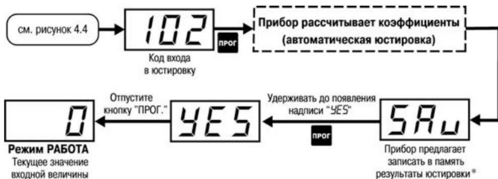
**Рисунок Д.8 – Последовательность действий при юстировке схемы компенсации температуры свободных концов ПТ**
