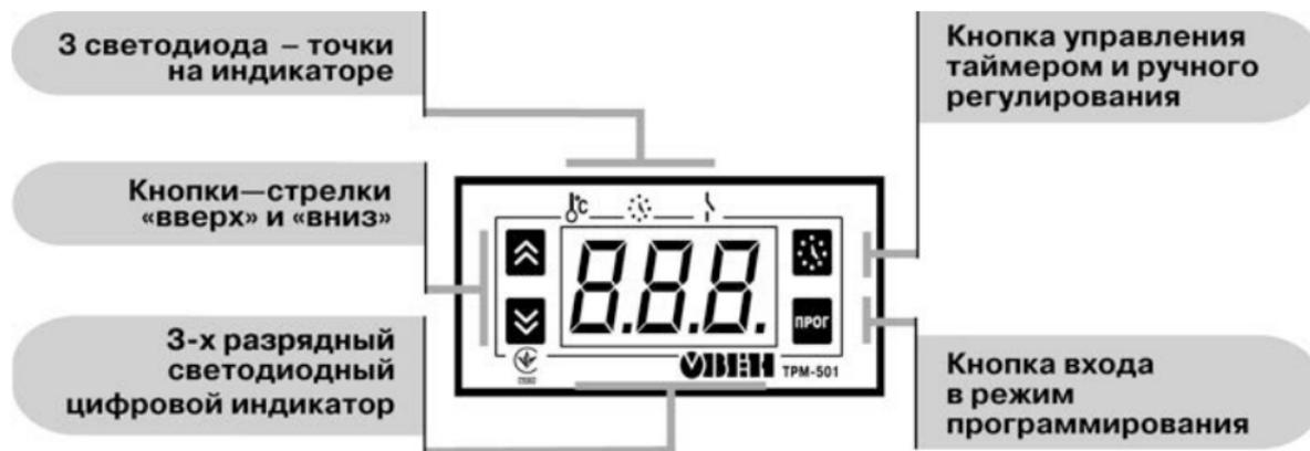
Рисунок 3.1 – Лицевая панель прибора
