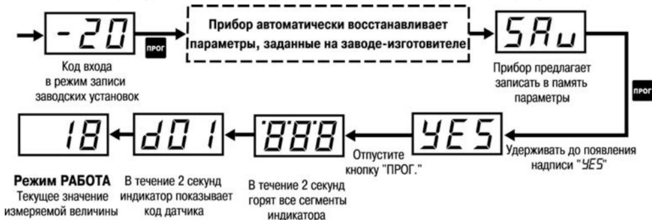
**Рисунок 4.2 – Схема действий при восстановлении заводских установок**
