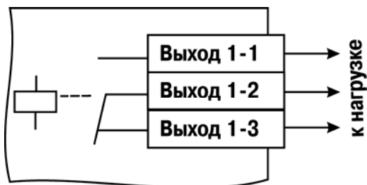
Рисунок Б.14 – Схема подключения нагрузки к ВЭ типа Р (для первого ВЭ)
