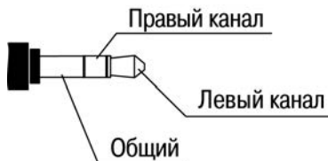
Рисунок 3.5 – Назначение контактов штекера для аудио-выхода
