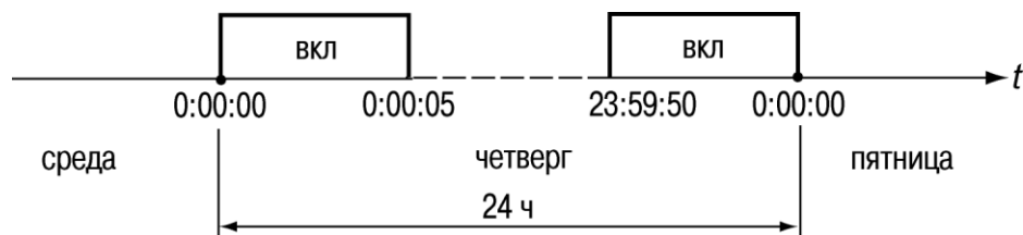
Рисунок Б.2 – Диаграмма включения выхода блока
