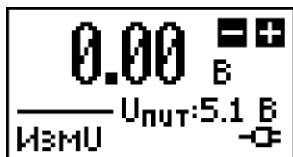
Рис.4. Экран прибора в режиме измерения напряжения
