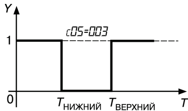
Рисунок 3.17 – Компаратор срабатывает вне установленных пределов
