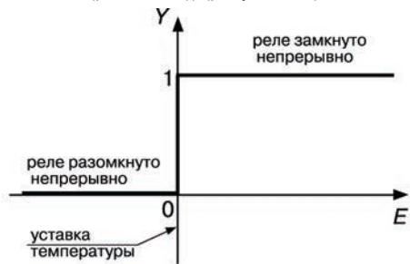
Рисунок 3.8 – Т-закон регулирования (релейный): полоса пропорциональности X_p равна нулю
