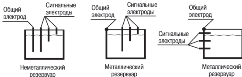
Рисунок 3.5 – Примеры установки кондуктометрических зондов
