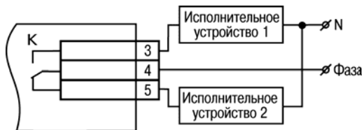
Рисунок Б.4 – Схема подключения нагрузки к ВУ типа Р
