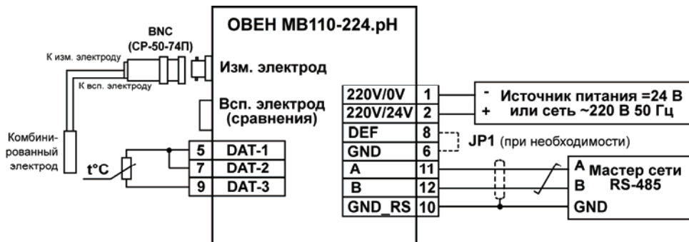
Рисунок 6.2 – Подключение к прибору внешних устройств с применением двухпроводной схемы подключения к датчику температуры и использованием комбинированного электрода
