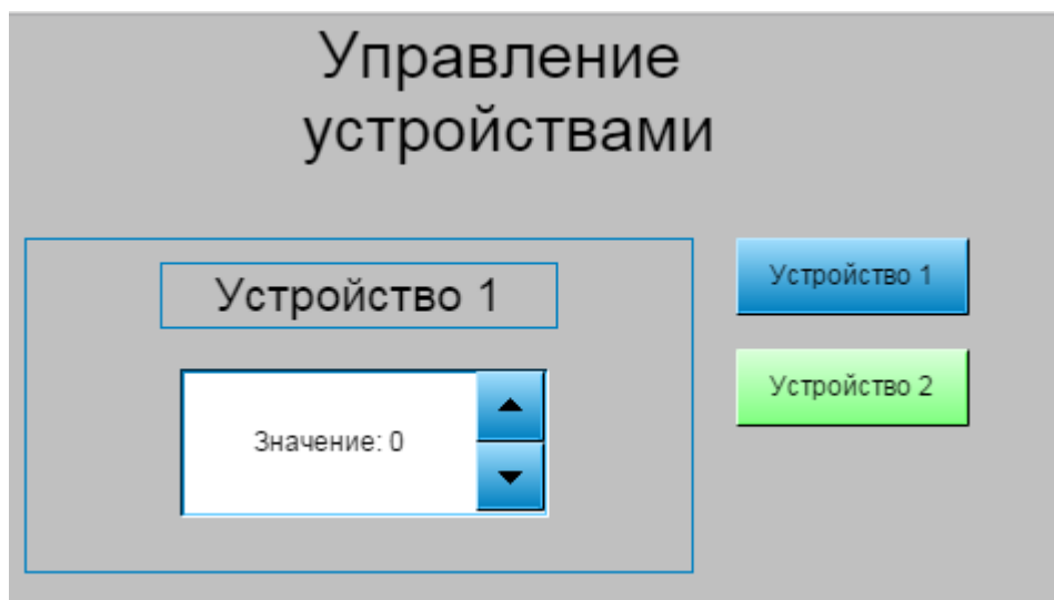
Рисунок 10.469 – Выделенная кнопка не соответствует отображаемому устройству
