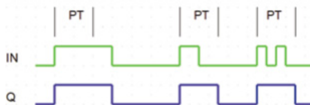
Рис. 15.35. Трассировка работы ФБ TMIN
