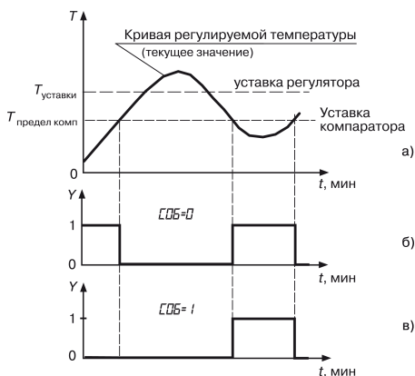
Рисунок 7.20 – Блокировка срабатывания компаратора до первого достижения уставки
