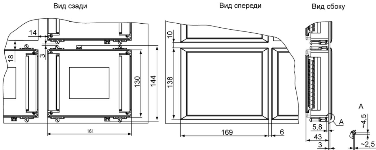
**Рисунок Б.4 – Размеры ОВЕН ТРМ32-Щ7, установленного в щит толщиной 3 мм**
