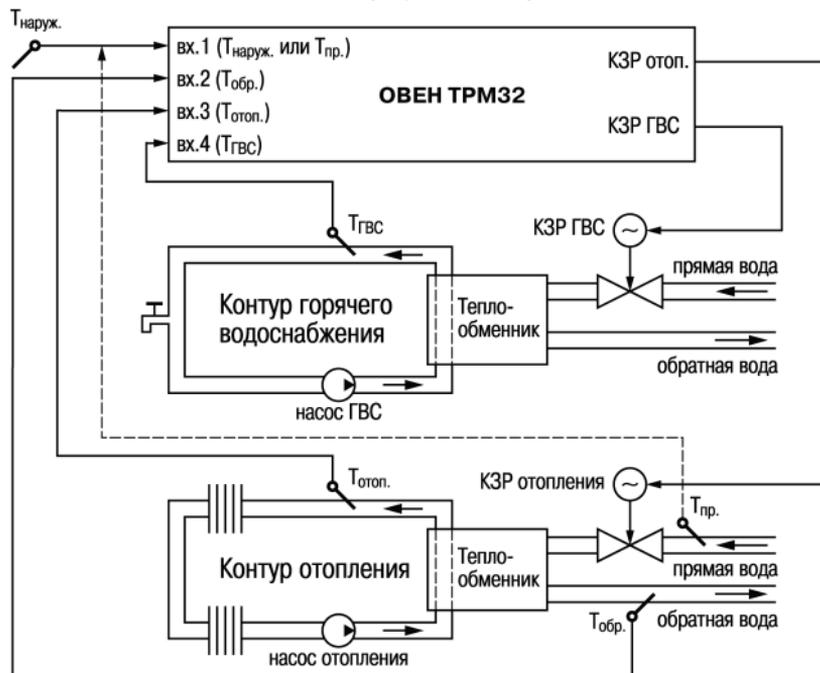
Рисунок А.1 – Схема системы отопления и ГВС
