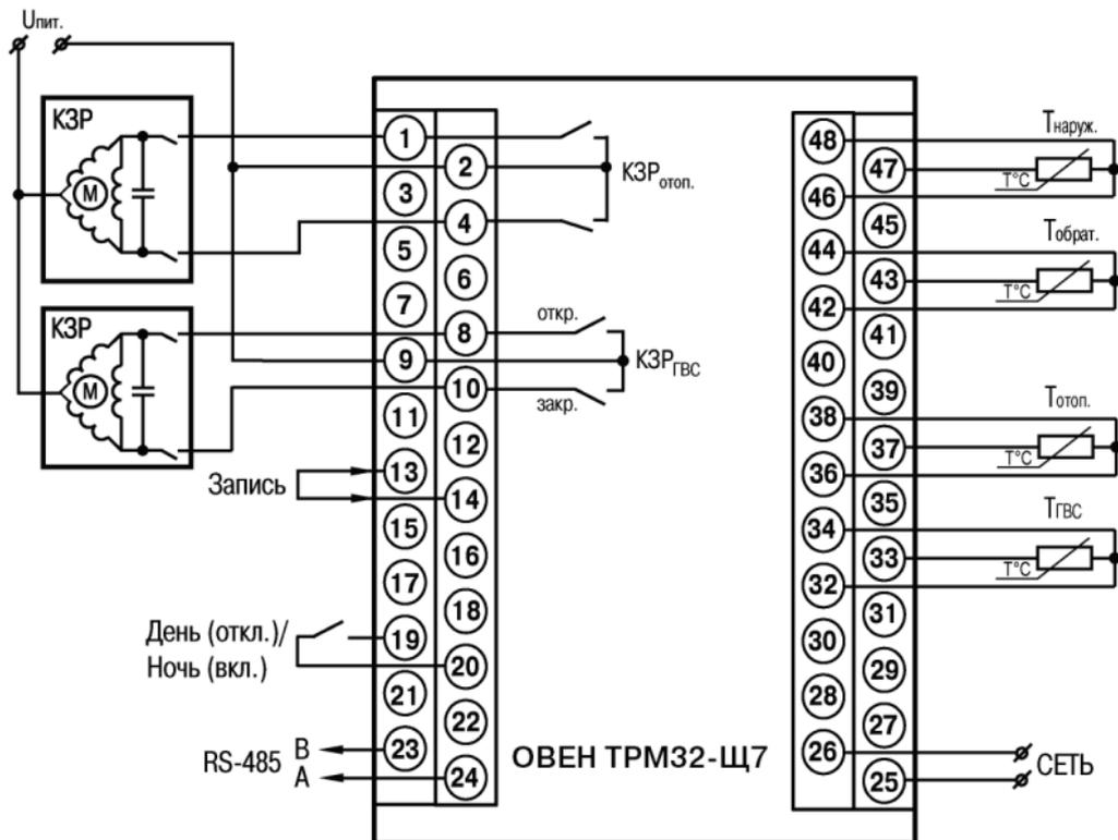
Рисунок В.3 – Схема подключения ОВЕН ТРМ32-Щ7
