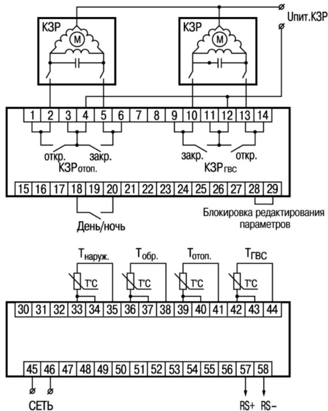
**Рисунок В.2 – Схема подключения ОВЕН ТРМ32-Щ4**
