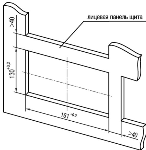
**Рисунок Б.2 – Габаритные и установочные размеры ОВЕН ТРМ32-Щ7**
