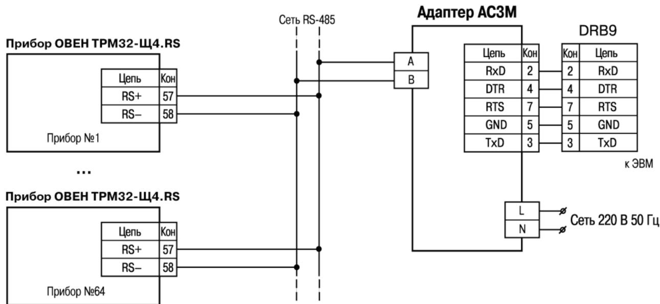
**Рисунок В.4 – Схема подключения ОВЕН ТРМ32-Щ4.01. RS и ОВЕН ТРМ32-Щ4.03. RS к адаптеру сети ОВЕН АС3М**
