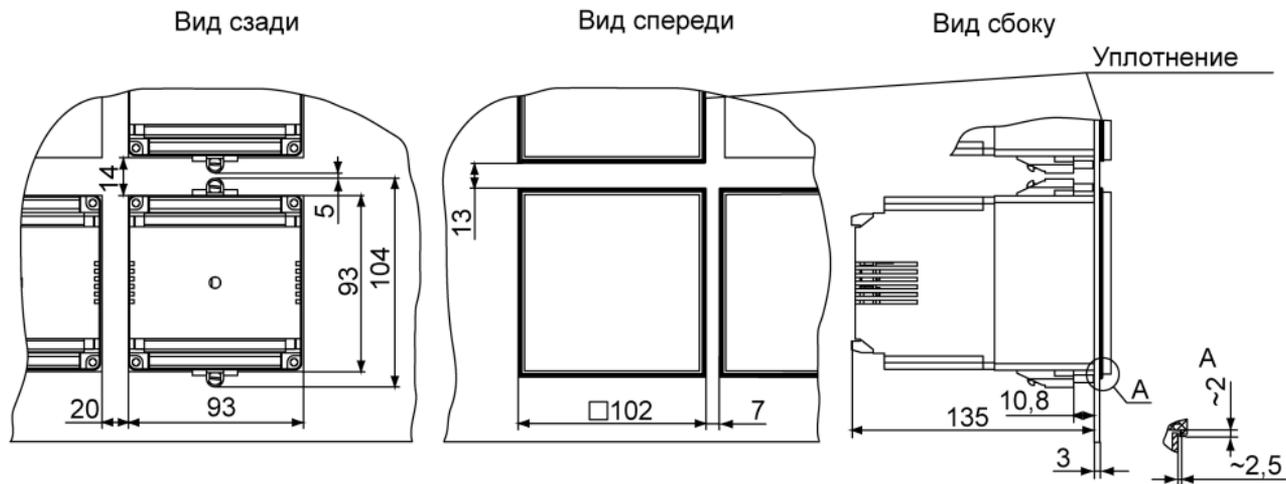
**Рисунок Б.3 – Размеры ОВЕН ТРМ33-Щ4, установленного в щит толщиной 3 мм**
