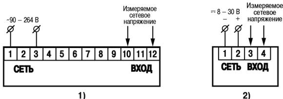
Рисунок 6.1 – Схемы подключения прибора в корпусе ЩЗ (1) и Щ9 (2)
