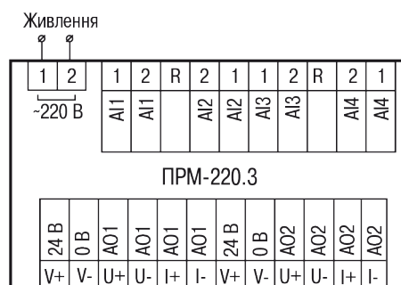
Рисунок 5.3 – Призначення контактів клемника пристрою із живленням 230 В
