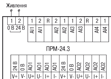
Рисунок 5.2 – Призначення контактів клемника пристрою із живленням 24 В
