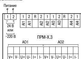
Рисунок 3 – Назначение контактов клеммника
