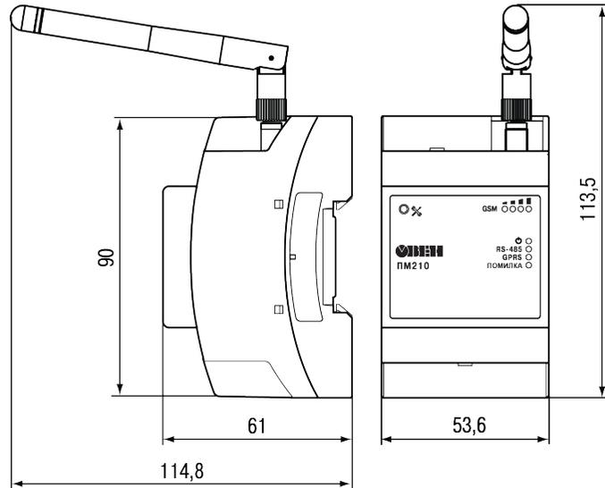
Рисунок 4 – Габаритные размеры ПМ210
