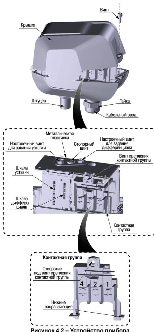
Рисунок 4.2 – Устройство прибора
