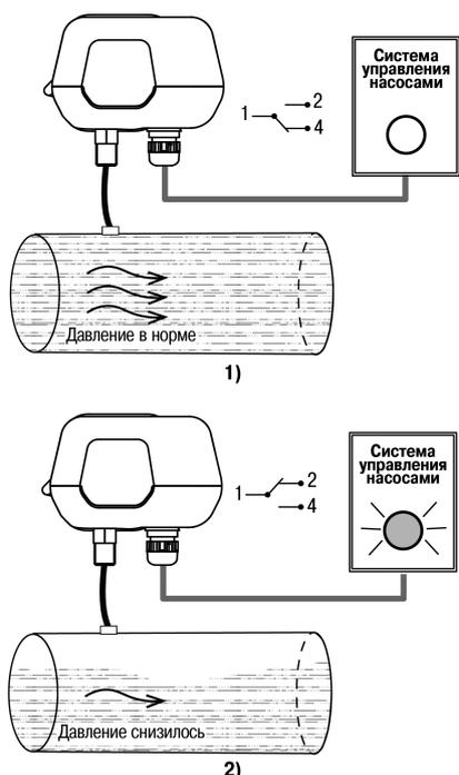
Рисунок 5.2 – Принцип действия прибора при давлении больше (1) и меньше (2) уставки
