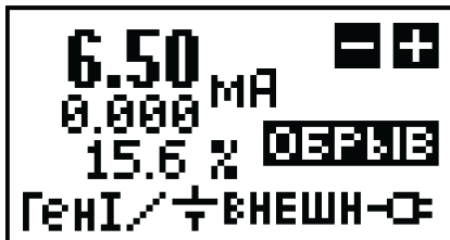
Рисунок 6.4 – Экран прибора в режиме генерации тока с плавным изменением задания
