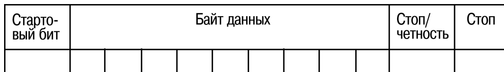
Рисунок 3.1 – Структура сообщения Modbus
