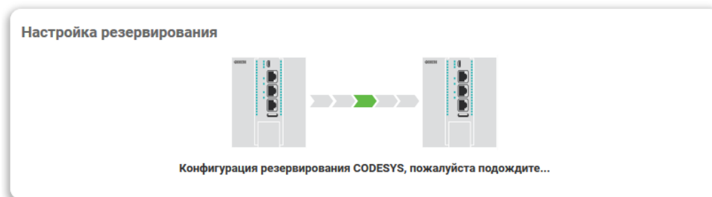
Рис. 2-25: Мастер настройки. Процесс конфигурирования резервирования
