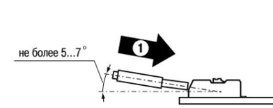
Рисунок 4 – Закрепление провода в клемме
