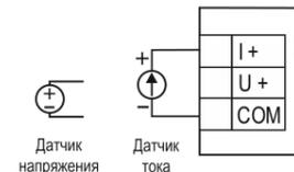
Рисунок 7 – Схемы подключения входных сигналов
