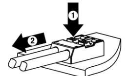
Рисунок 5 – Извлечение провода из клеммы
