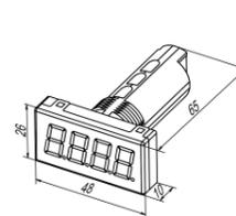
Рисунок 2 – Габаритные размеры корпуса Щ9
