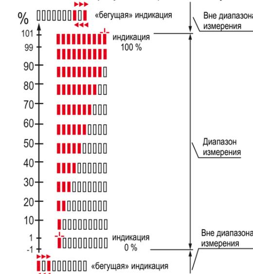
Рисунок 15 – Отображение измеряемого сигнала
