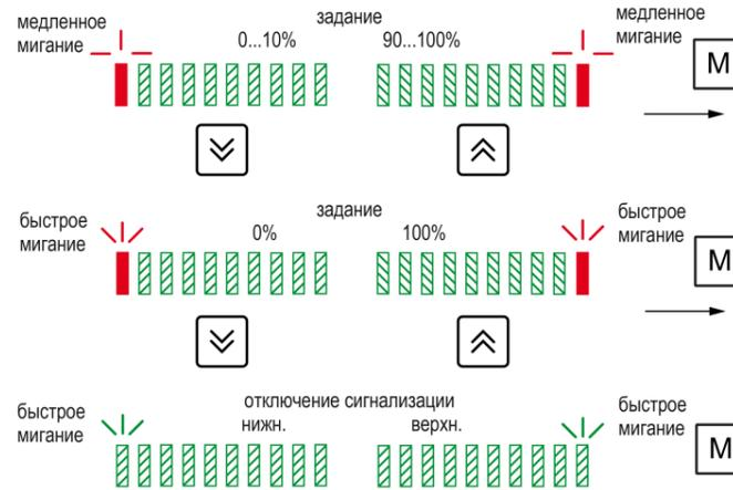
Рисунок 13 – Установка сигнализации на границах измеряемого диапазона
