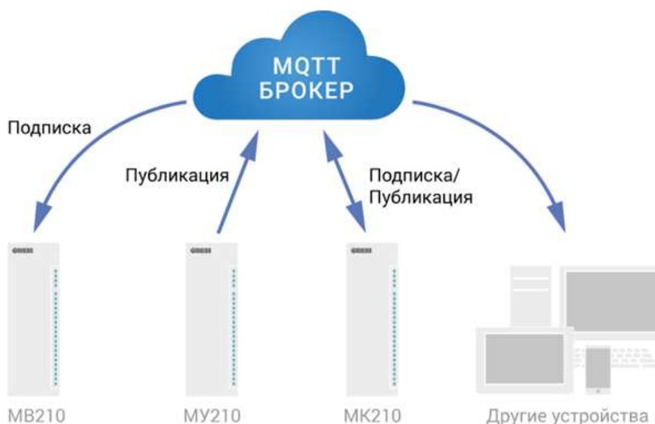
Рисунок 6.2 – Структурная схема обмена по протоколу MQTT
