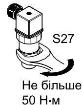
Рисунок 2 – Затягування гайки штуцера
