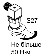
Рисунок 2 – Затягування гайки штуцера
