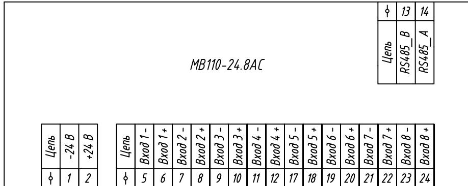
Условно-графическое обозначение прибора
