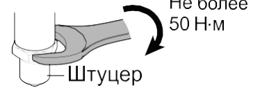
Рисунок 2 – Затягивание гайки штуцера
