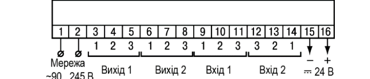
Рисунок 5 – Призначення контактів клемної колодки пристрою у настінному Н та щитових Щ1, Щ2 типах корпусів
