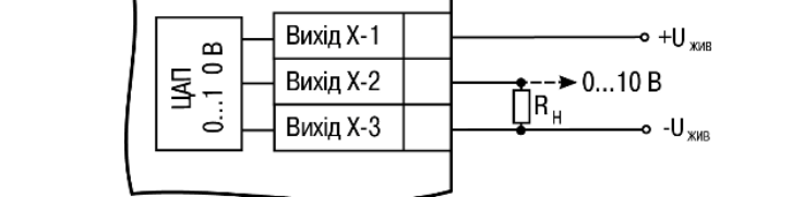
Рисунок 19 – Схема підключення навантаження із вимірювальним шунтом
