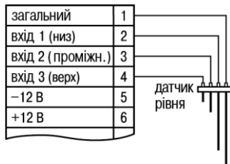
Рисунок 5.3 – Схема підключення кондуктометричних датчиків рівня
