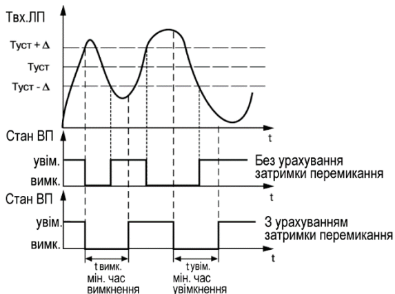
Рисунок 7.11 – Робота із затримкою перемикавання
