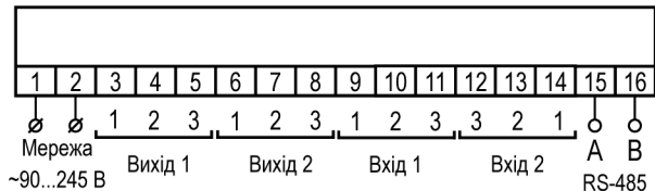
Рисунок 5.2 – Загальна схема підключення TPM202-Н, -Щ1 і -Щ2
