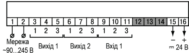
Рисунок 5.2 – Призначення контактів клемної колодки пристрою у настінному Н і щитовому Щ1, Щ2 типах корпусів
