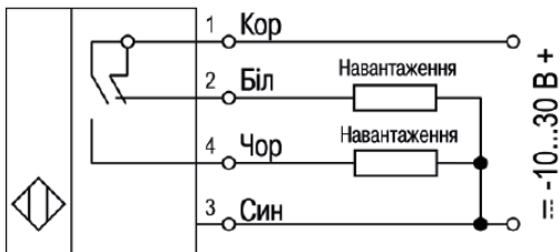
Рисунок 6 – Схема підключення NO/NC датчика з виходом PNP-типу
