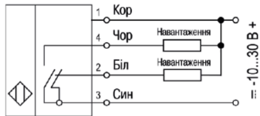
Рисунок 5 – Схема підключення NO/NC датчика з виходом NPN-типу
