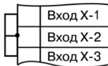
Рисунок Б.9 - Схема установки перемычек на неиспользуемый вход
