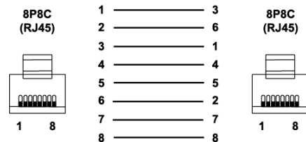
Рисунок 4 – Схема перехресного кабелю для підключення пристрою по мережі Ethernet
