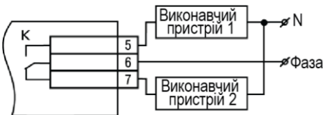
Рисунок 13 – Схема підключення навантаження до ВП типу Р
