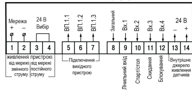
Рисунок 9 – Призначення контактів клемника
